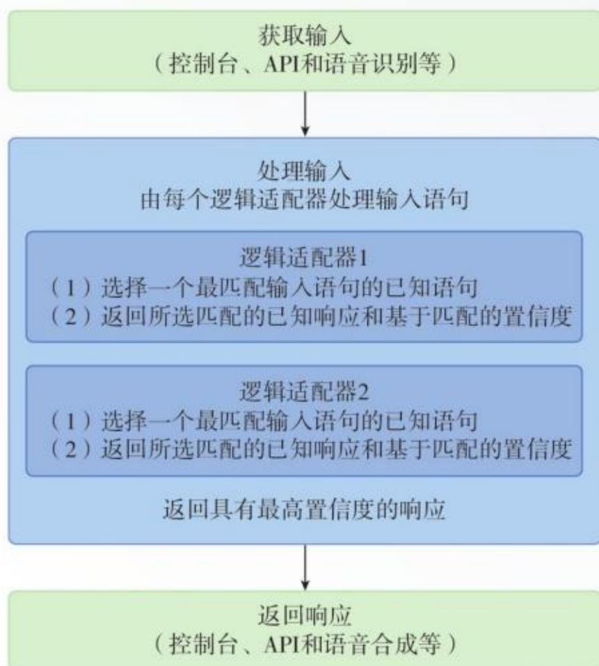
图 3.2.7 ChatterBot 的处理流程图
