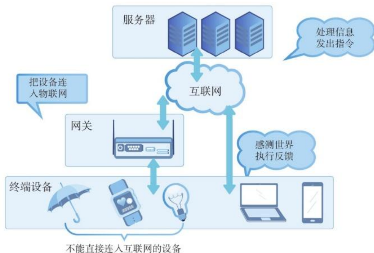
图4.1.2 物联网的硬件结构
