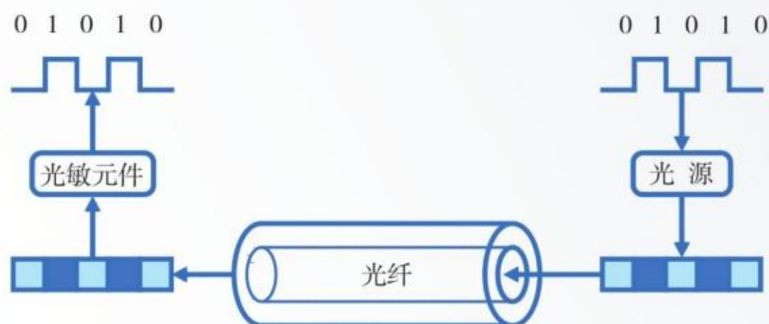
图 1.2.6 光纤通信原理示意图
