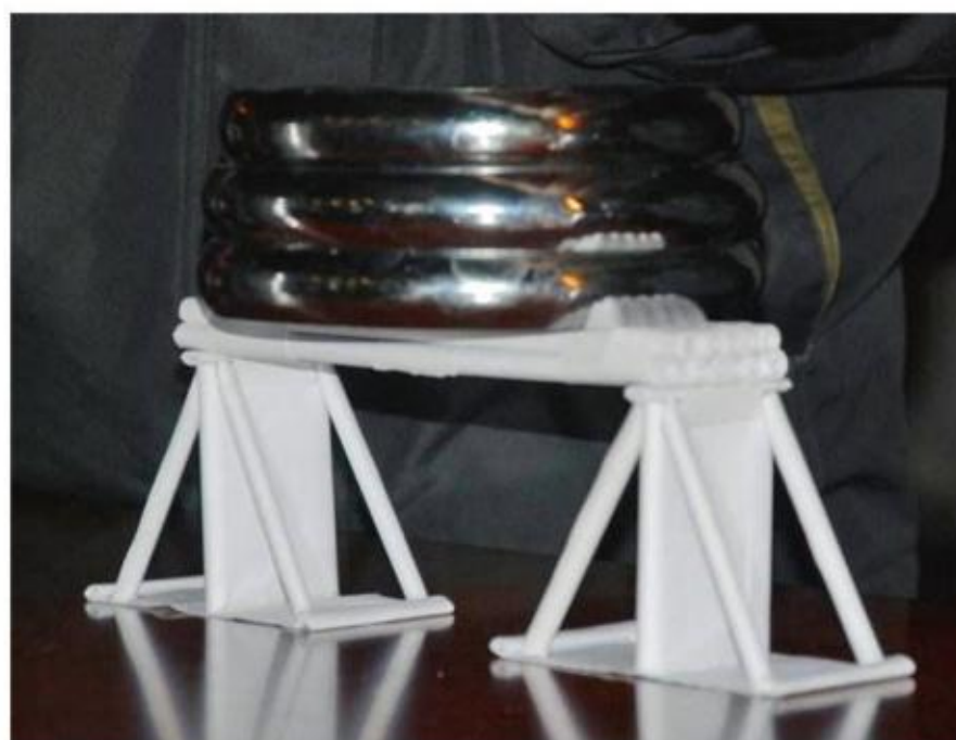
图2-6 纸桥加载重物
