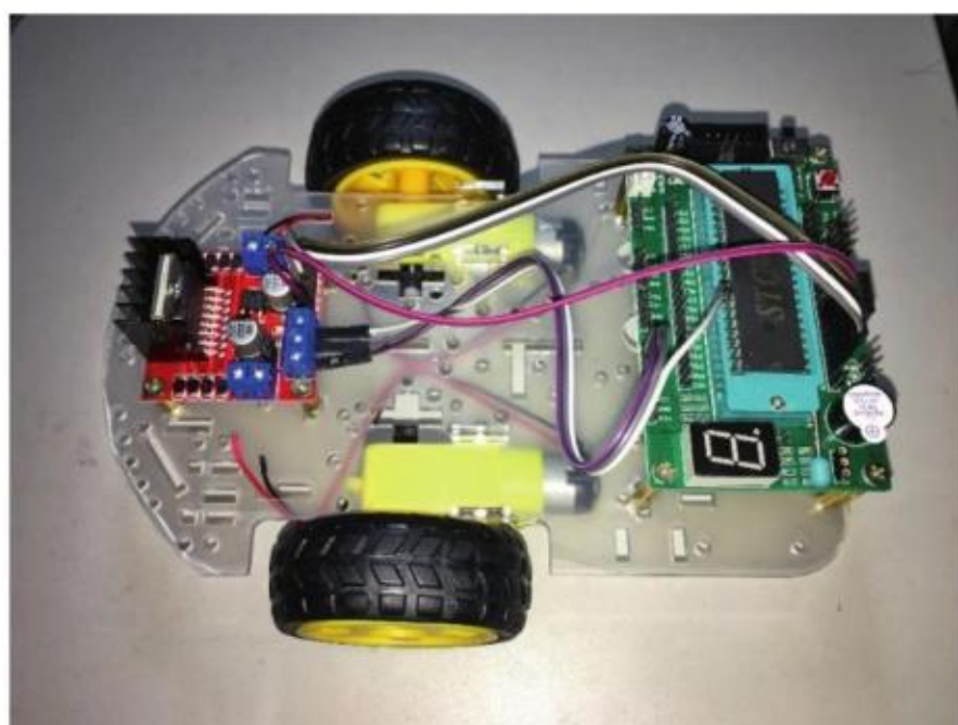
图 1-57 安装单片机和电机驱动模块并连线
