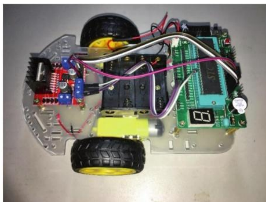
图 1-58 安装电池盒组件并连线
