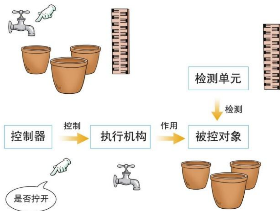
图4-6 水缸水位控制系统组成部分
