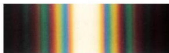
图 4.5-3 白光的单缝衍射条纹
