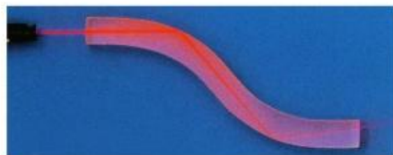
图 4.2-6 弯曲的有机玻璃棒能导光
