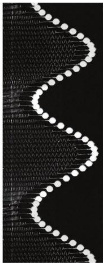
图 2.1-2 弹簧振子的频闪照片
