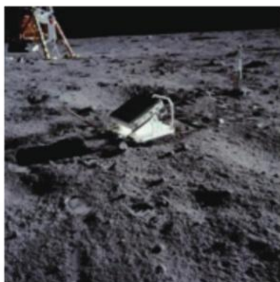
图 4.6-7 阿波罗 11 号宇宙飞船宇航员在月球安置的激光反射器
