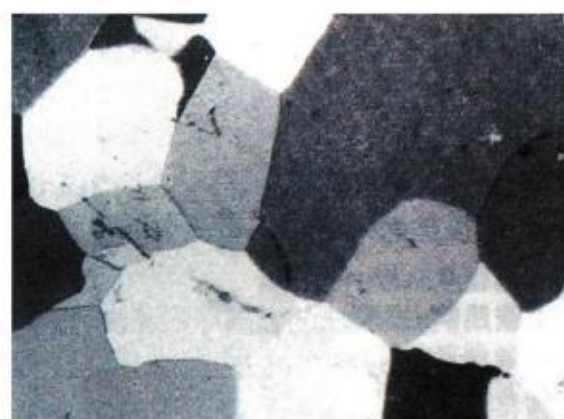
图2.4-7 金相显微镜下的铝—锂—锰合金
