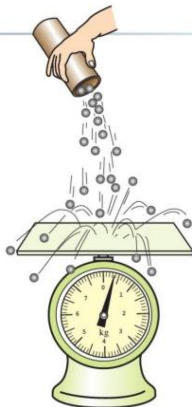
图 1.3-4 模拟气体压强产生机理的实验
