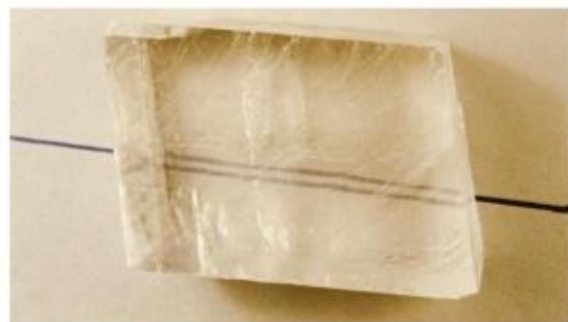
图2.4-6 方解石的双折射现象
