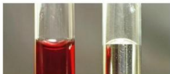
图2.5-5 玻璃管中的水和水银
