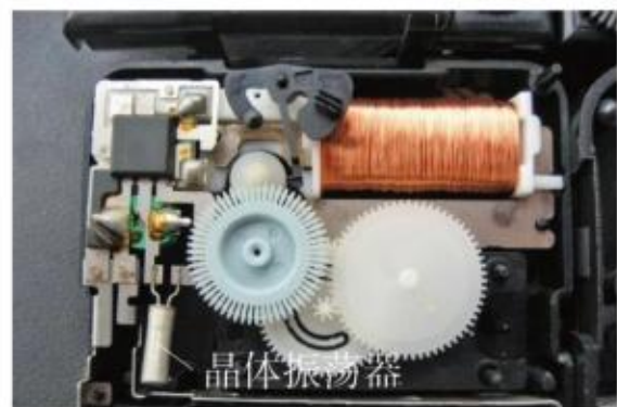
图4.1-4 石英电子钟里的晶体振荡器
