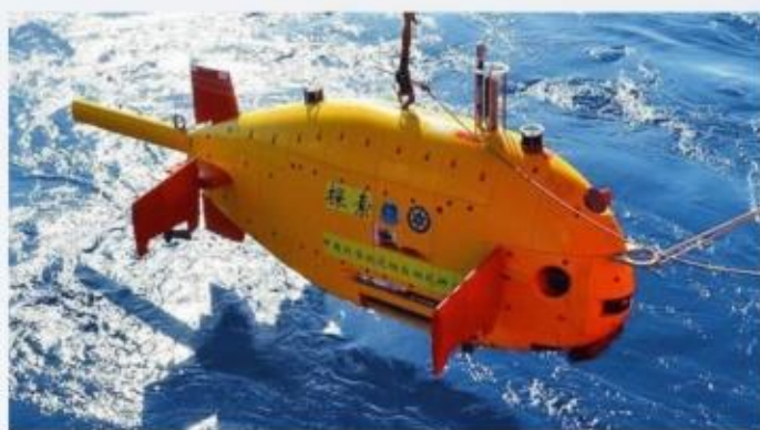
丙 我国自主研发的探索号自治式水下机器人
