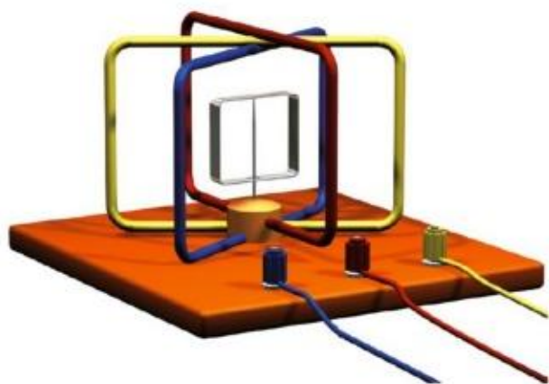
图 2.3-11 产生旋转磁场的装置
