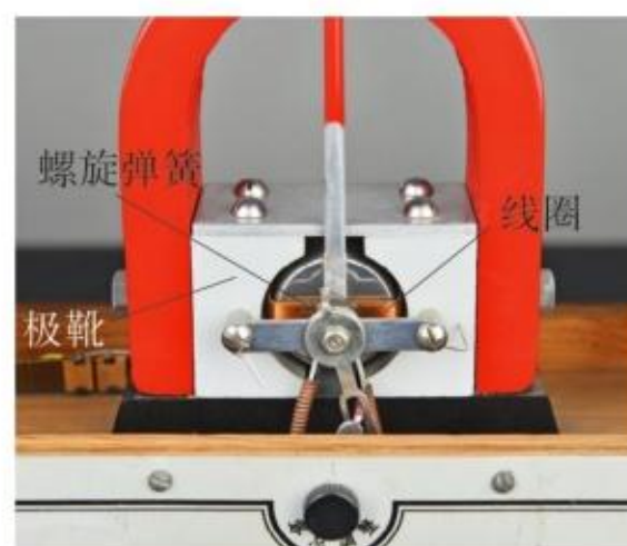
图 1.1-6 磁电式电流表的结构
