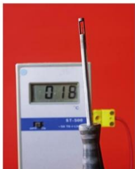
图 5.1-7 热电偶温度计
