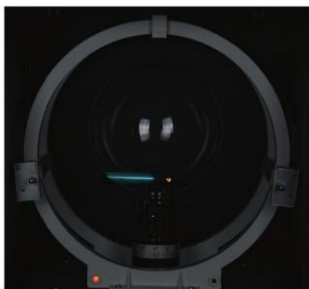
图1.3-3 没有磁场时电子束沿直线运动
