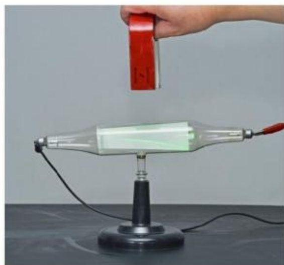
图1.2-1 电子束在磁场中受力偏转
