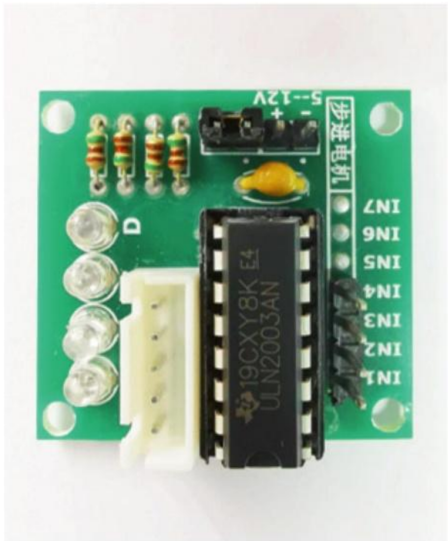
图3-27 ULN2003驱动电路模块实物
