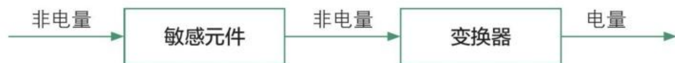
图2-6 传感器的组成原理示意图
