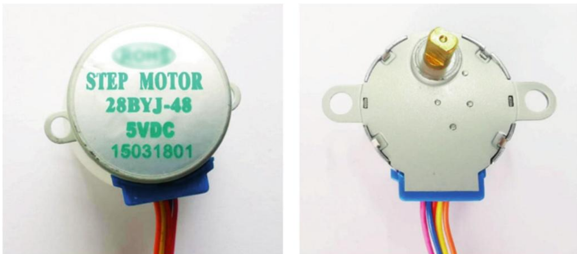
图 3-30 28BYJ-48 步进电机实物
