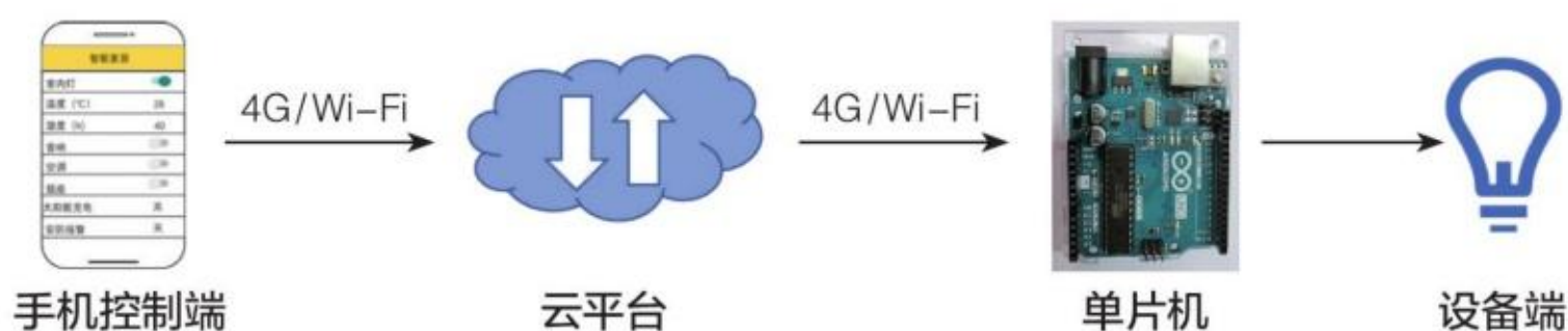
图4-3 室内智能灯光控制系统示意图
