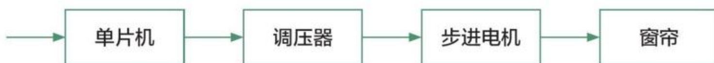
图 3-25 开环控制的窗帘控制系统
