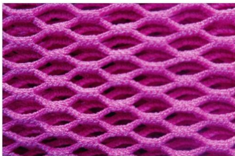
图1-13 面料蜂巢结构微观示意
