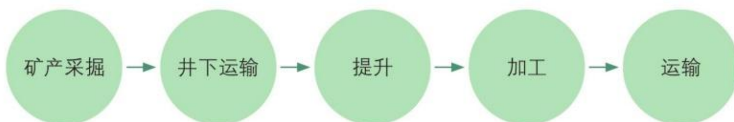
图 2-33 煤炭生产流程图
