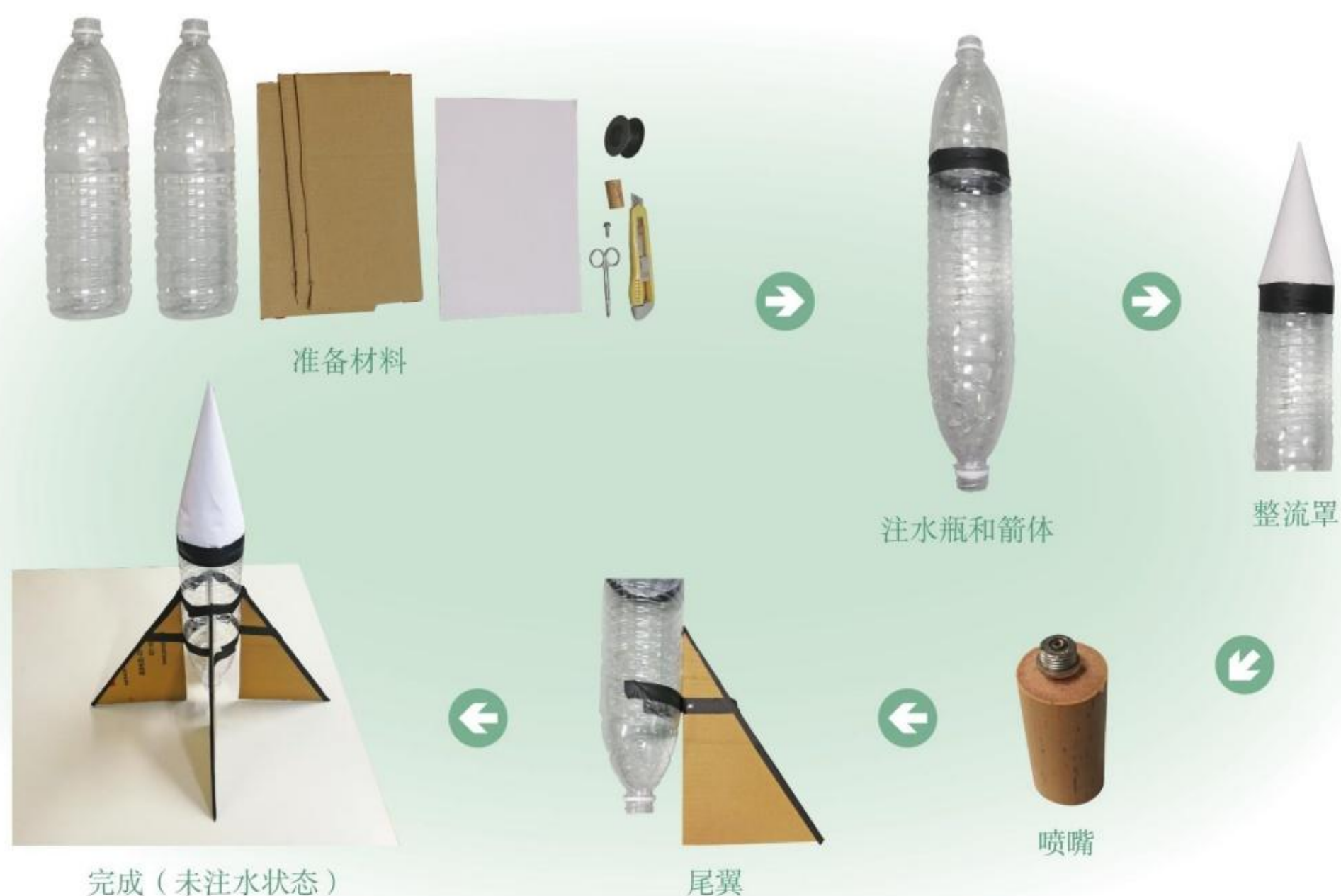
图1-35 水火箭主要制作步骤示意
