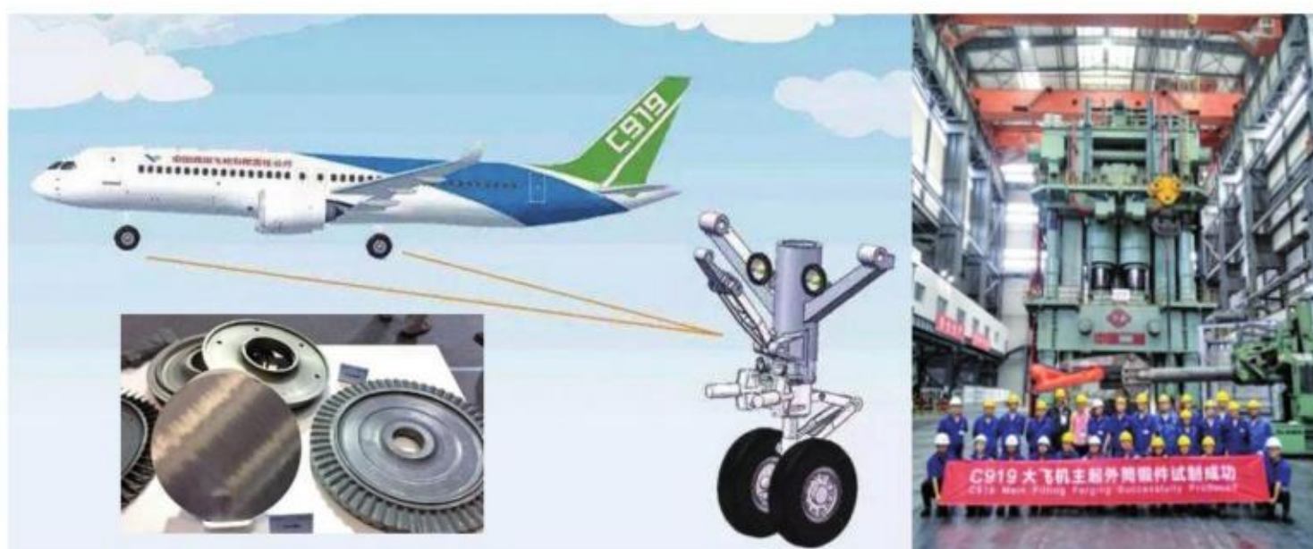
图1-48 C919“双脚”关键材料300M超高强度钢及其锻压加工国产化
