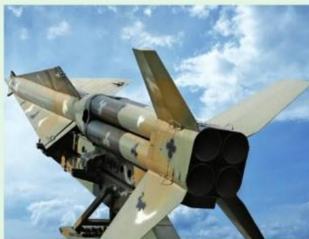
图 1-16 金属基复合材料在球拍、发动机风扇叶片、导弹尾翼和舰船螺旋桨中的应用
