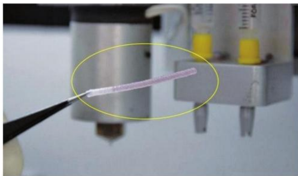
图1-49 4D打印智能材料人工血管
