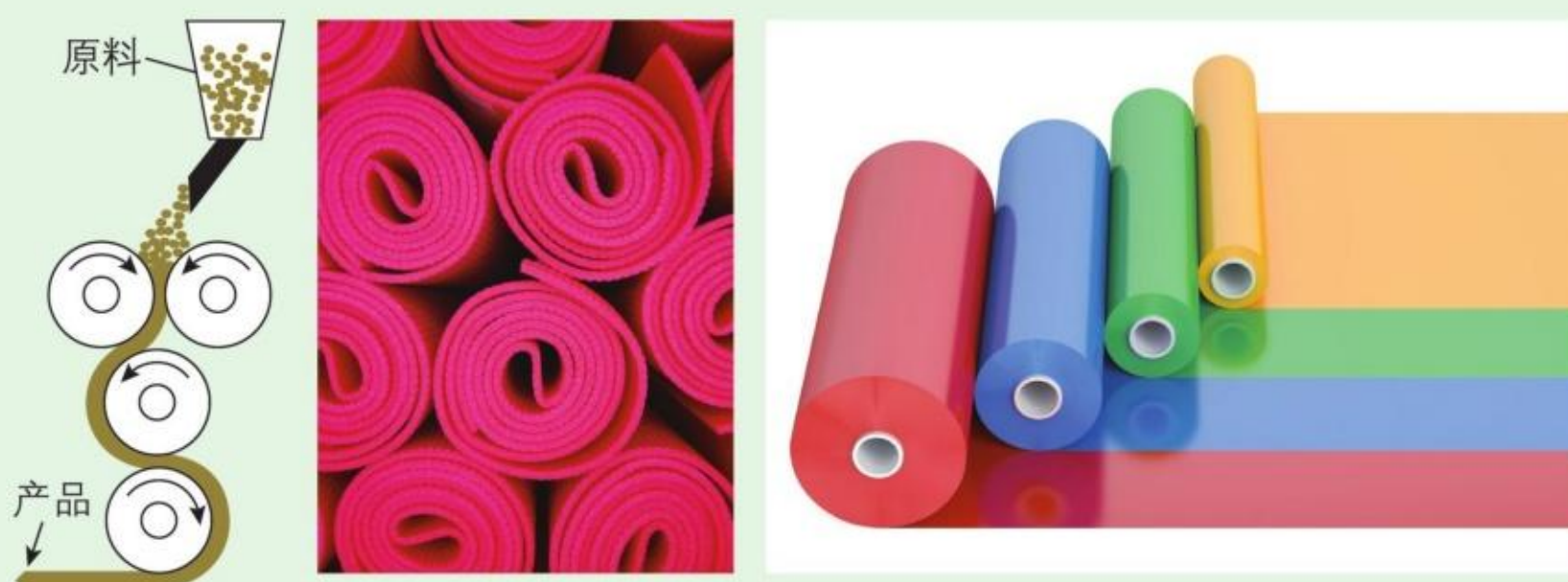
图1-28 压延成型工艺（左）及制品（中、右）
