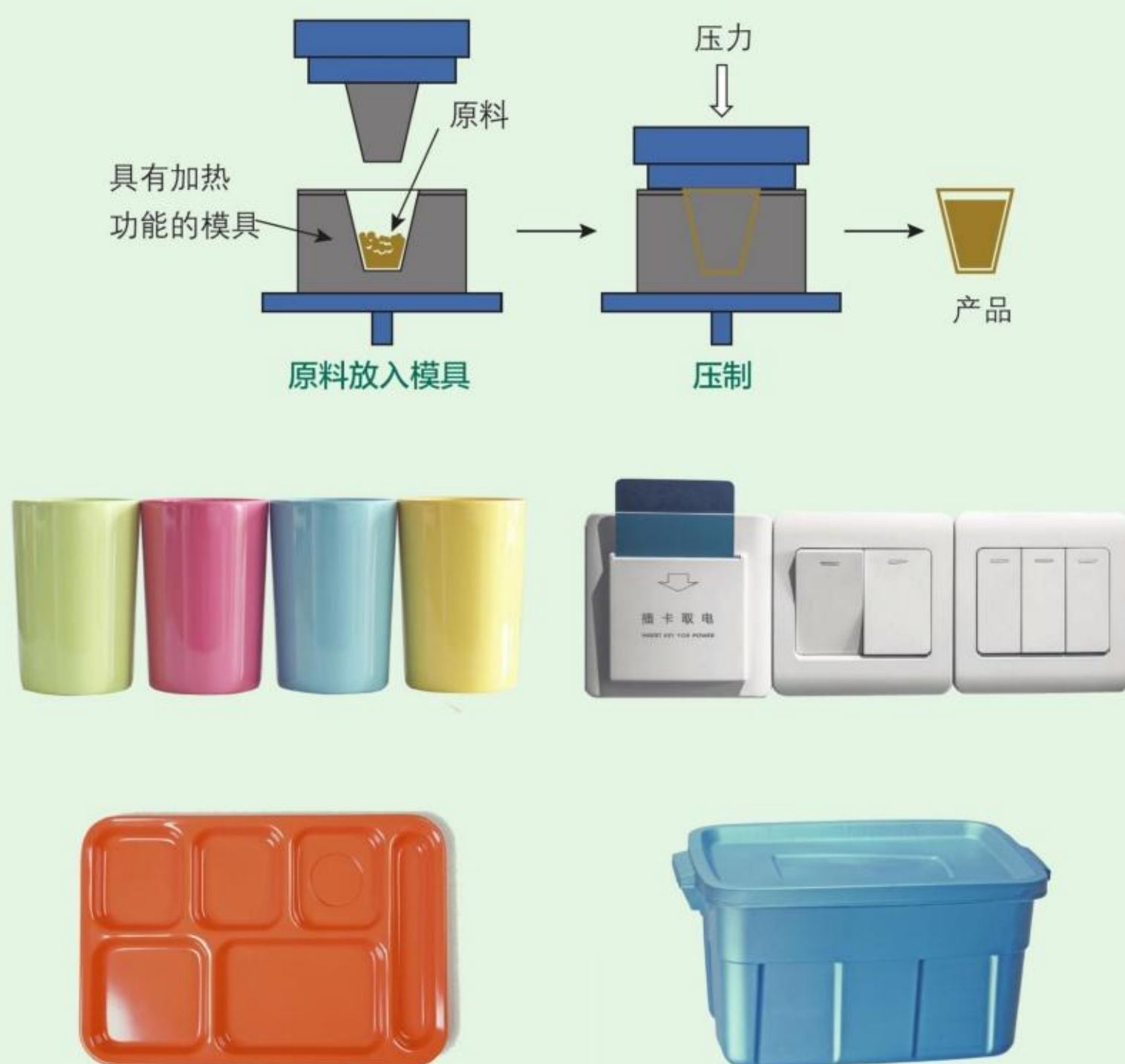
图1-26 模压成型工艺（上）及制品（中、下）
