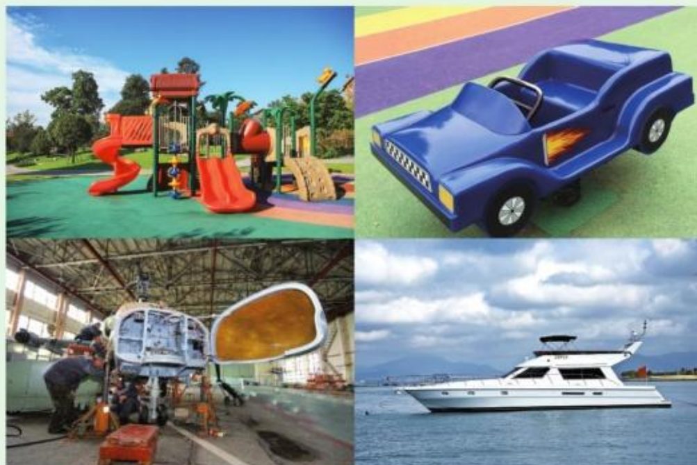
图1-32 复合材料手糊成型工艺（左）及制品（右）
