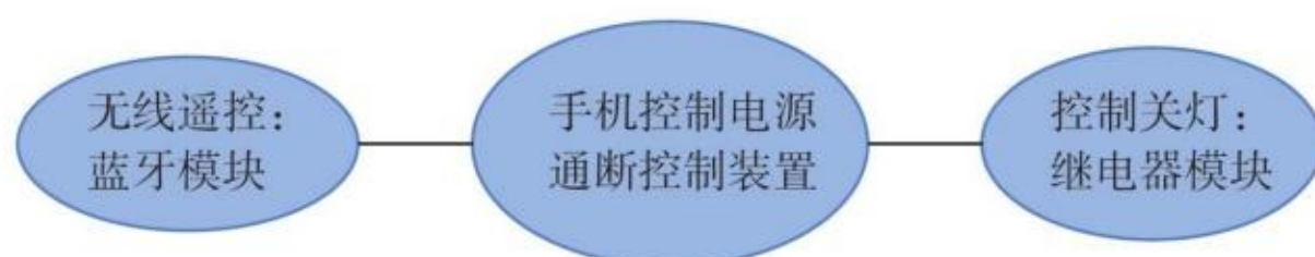
图3.2.3 手机控制电源通断装置功能设计
