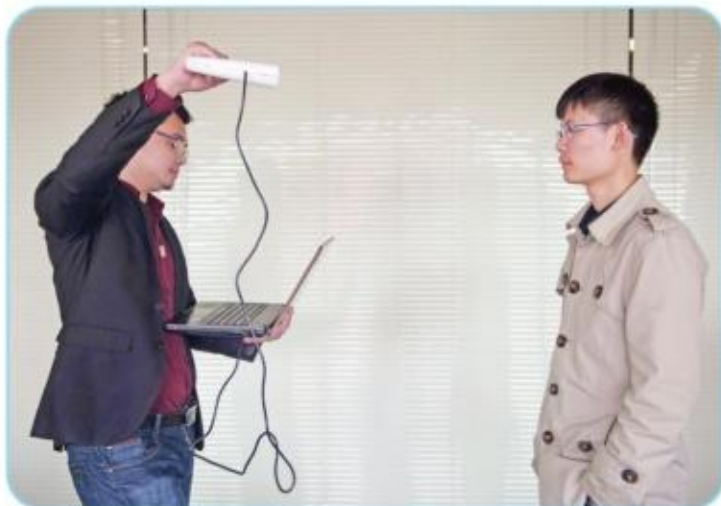
图1.2.10 利用手持三维扫描仪扫描人体
