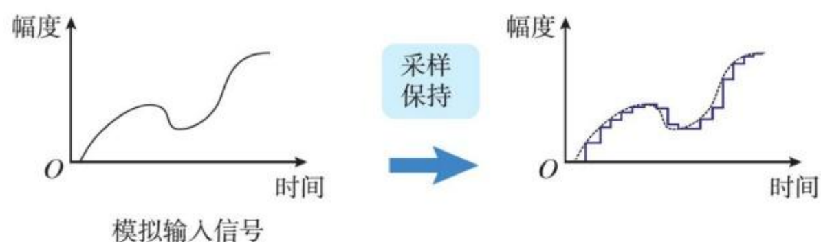
图 2-2 模数转换基本原理
