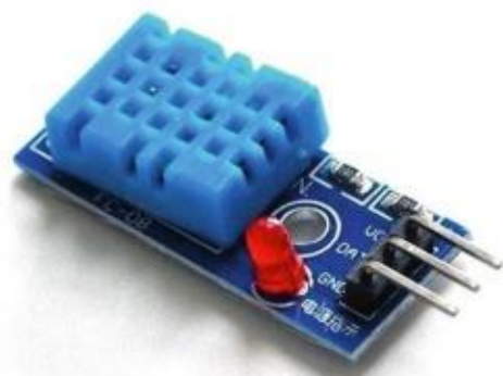
图3-9 焊接了DHT11数字温湿度传感器的电路板
