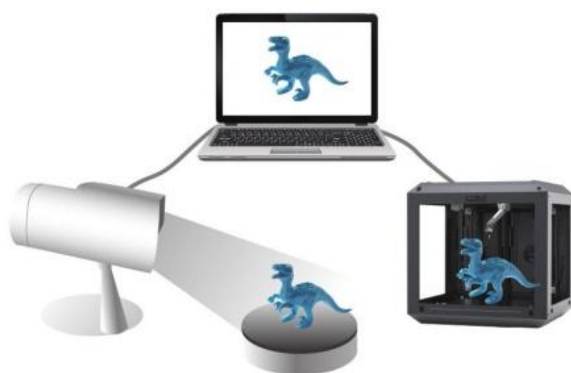
图1-9 通过三维扫描获取物体信息并打印模型过程示意图
