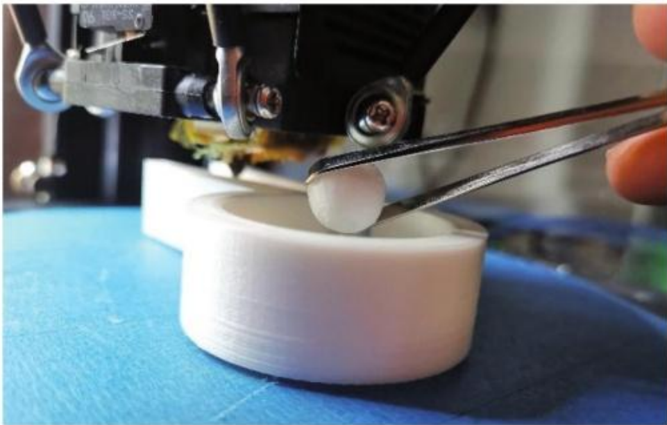
图4-5 暂停打印并放入弹子
