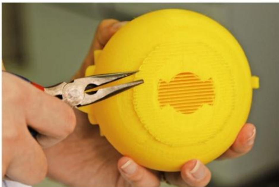
图 1-11 去除打印支撑
