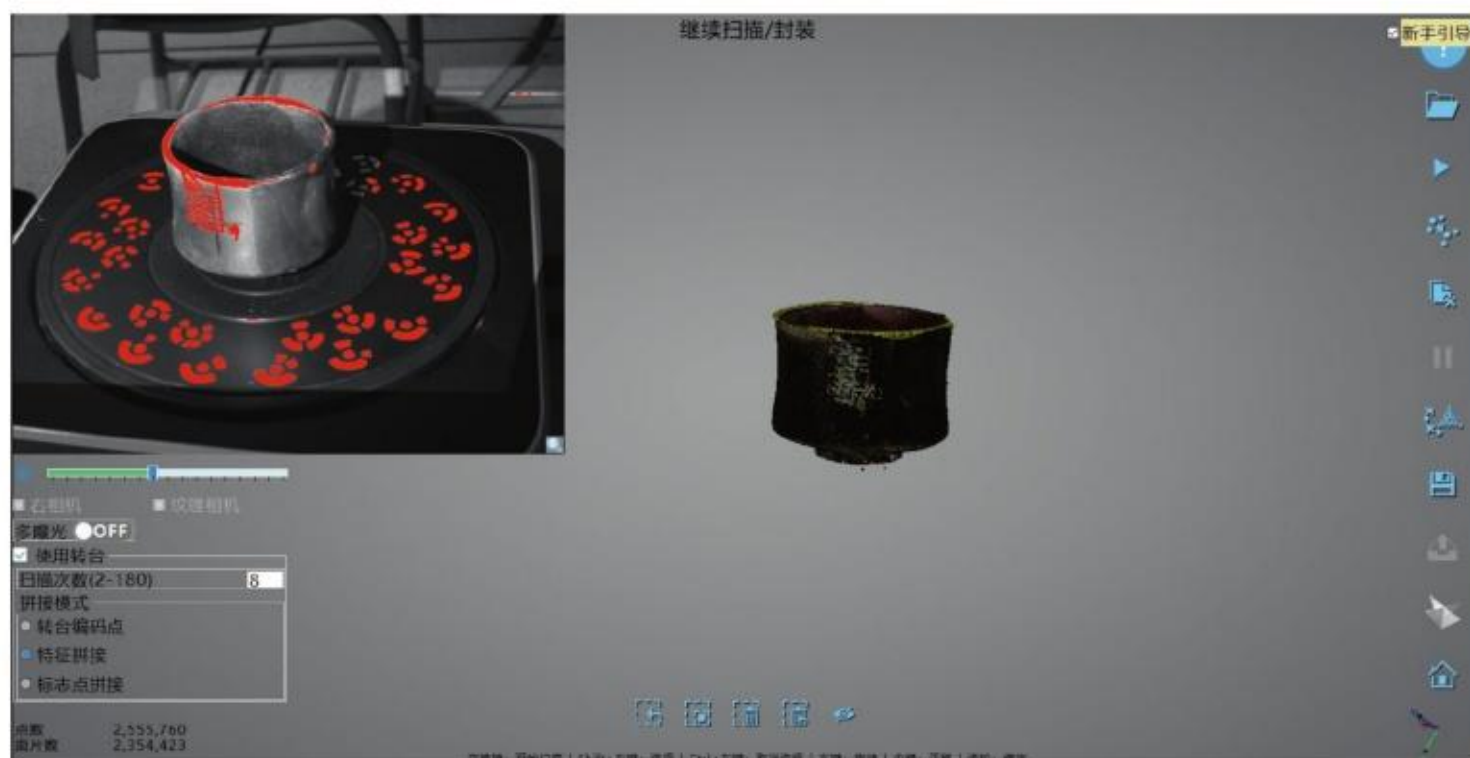
图4-19 陶杯点云拼接处理
