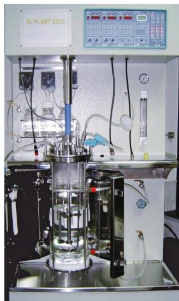
▲ 图2-8 一种用于植物细胞培养的反应器
