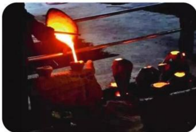
5. 铸造。高温把铜化成铜水灌注到做好的石英壳或砂箱里面。
