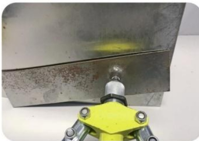
5. 将钉子插入两片金属板的钻孔中，压紧 铆钉枪。
