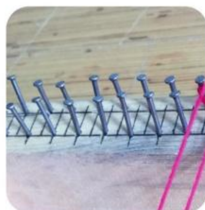
② 以S形状将毛线缠绕在综框两边的齿梳木条上。其中经线要绷紧，为下一步做好准备。
