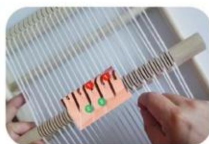
② 排线的时候注意深浅凹槽，将经线一上一下排列好，形成上、下两个水平面。
