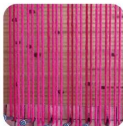
② 以S形状将毛线缠绕在综框两边的齿梳木条上。其中经线要绷紧，为下一步做好准备。
