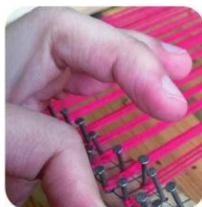
② 以S形状将毛线缠绕在综框两边的齿梳木条上。其中经线要绷紧，为下一步做好准备。
