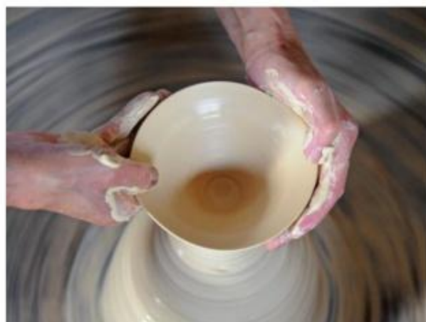
▲ 工匠使用坯车制坯
