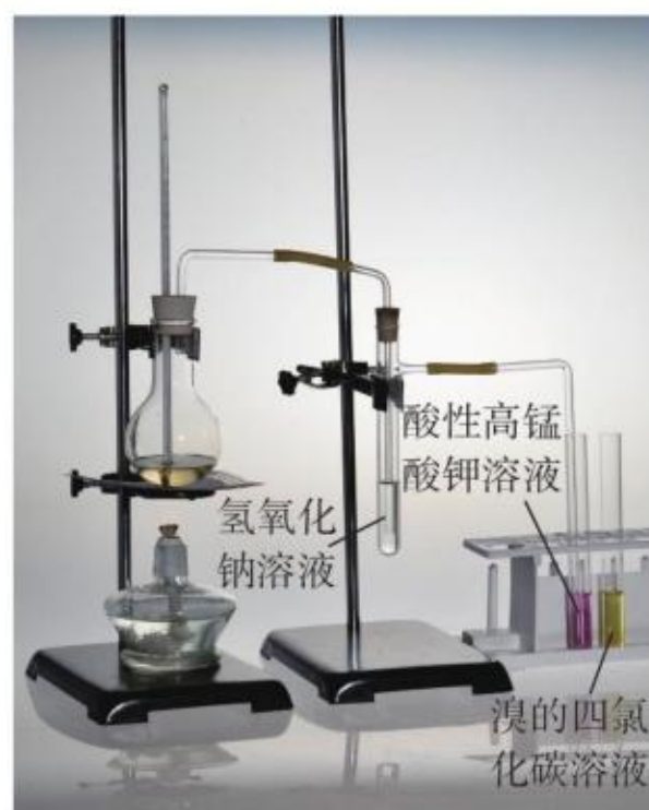
图3-9 乙醇的消去反应
