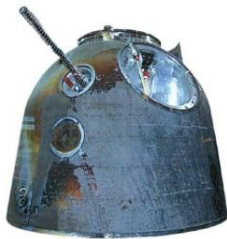
图5-5 宇宙飞船返回舱烧蚀后的外壳
