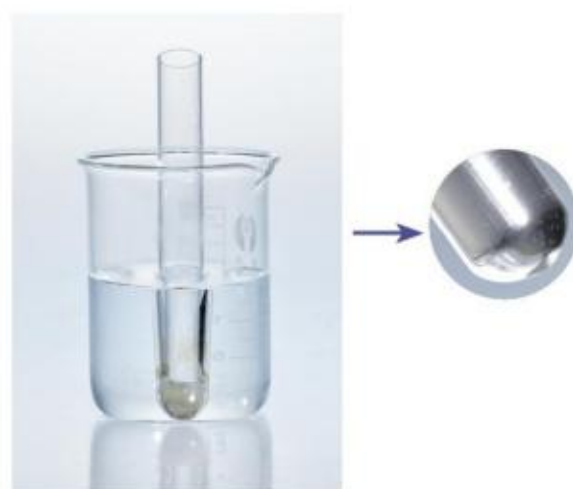
图3-17 乙醛的银镜反应
