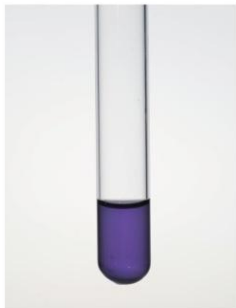
图3-14 苯酚与氯化铁反应
