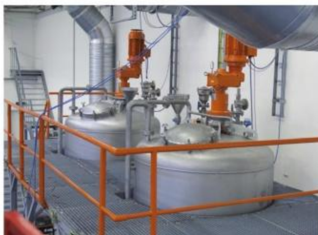
图3-32 工业化合成使用的反应釜
