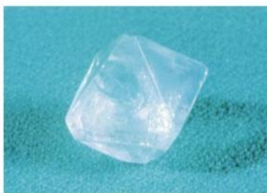
图 3-35 制取明矾晶体的结晶装置及完美的明矾晶体的照片
