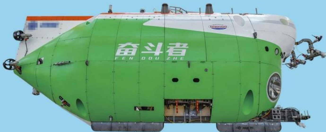
我国“奋斗者”号载人潜水器采用了创新设计的锂离子电池系统
