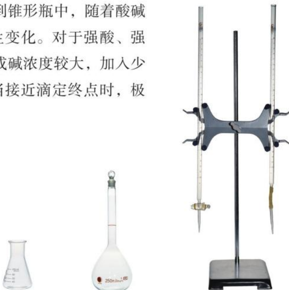
图3-10 酸碱中和滴定常用的仪器
