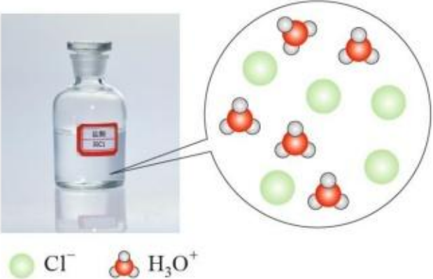
图3-1 HCl在水中电离示意图
