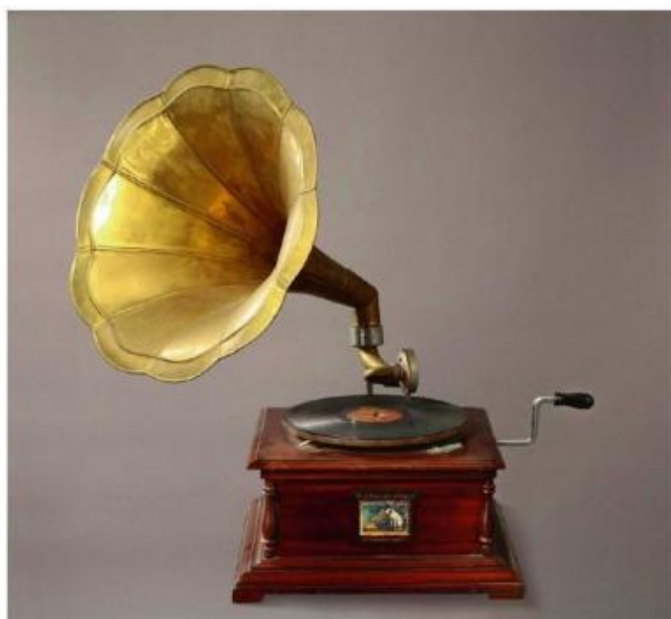
玻里纳研制的圆盘式留声机
