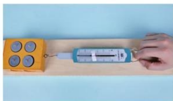
图 3.2-4 测量静摩擦力的实验装置
