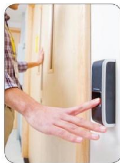
图2.2.10 自动门禁系统中通过感应设备采集指纹
