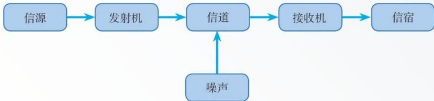
图1.1.9 通信系统模型示意图
