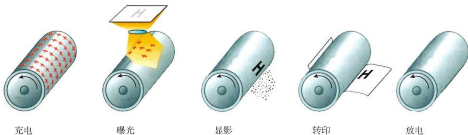
图9.4-9 静电复印的工作流程
