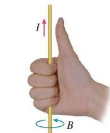
图 13.1-7 直线电流的安培定则
