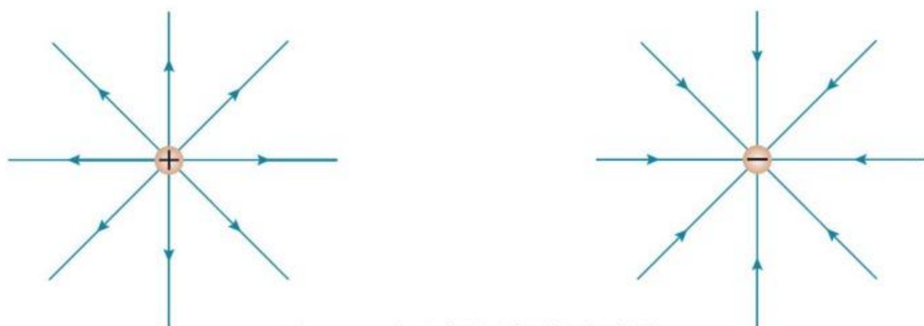
图9.3-7 点电荷的电场线呈辐射状
