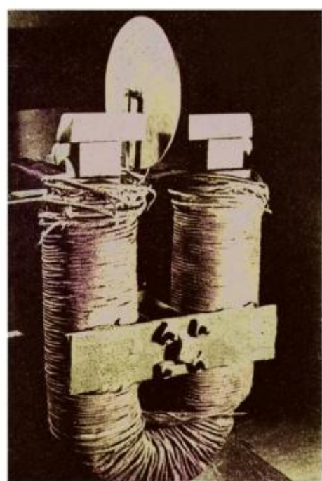
图 13.3-5 法拉第的圆盘发电机
