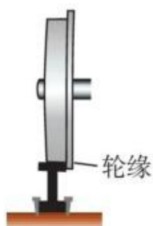
图6.4-1 火车车轮有突出的轮缘
