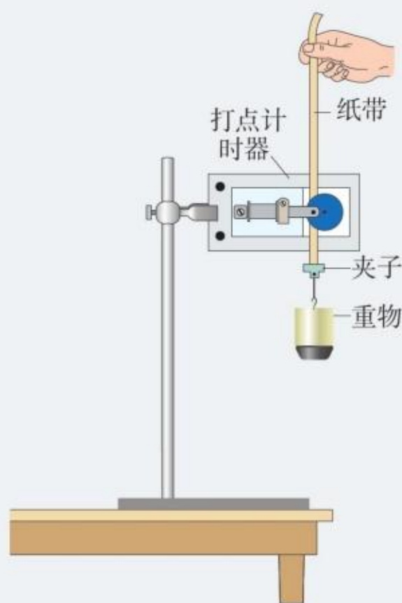
图8.5-2 研究自由下落物体机械能的实验装置
