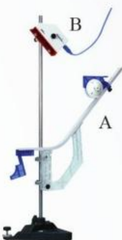
图5.3-5 用传感器研究平抛运动的装置
