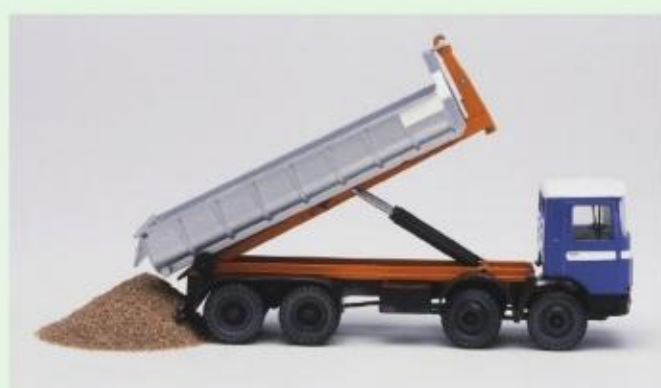
图1-15 自动翻转卸料装置设计
