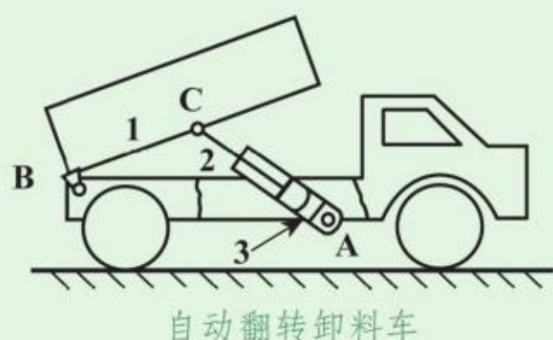
图1-15 自动翻转卸料装置设计
