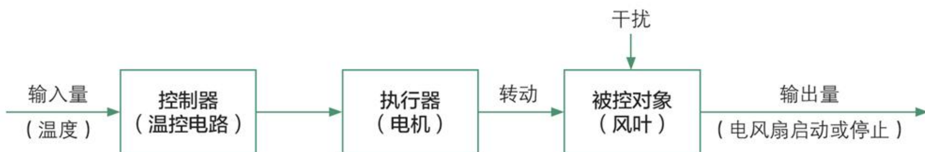
图4-22 温控电风扇控制系统方框图
