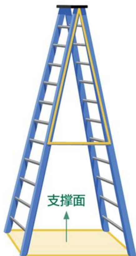
图 1-26 人字梯形状与支撑面示意图
