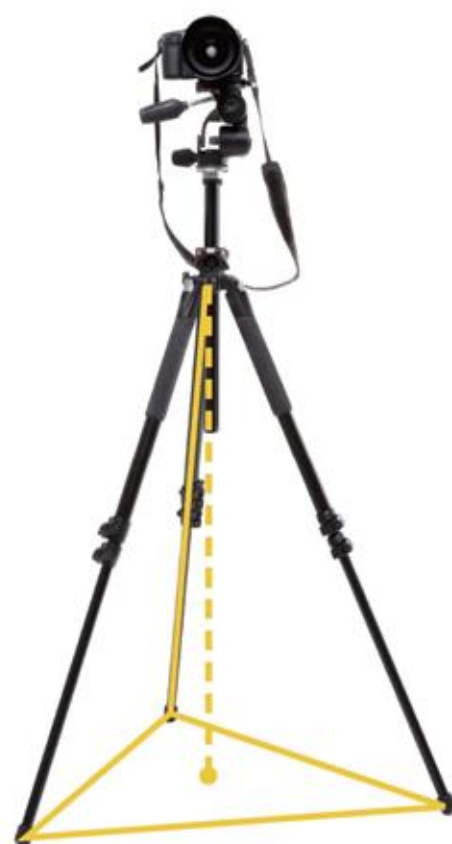
图 1-28 照相机三脚架结构与重心投影示意图
