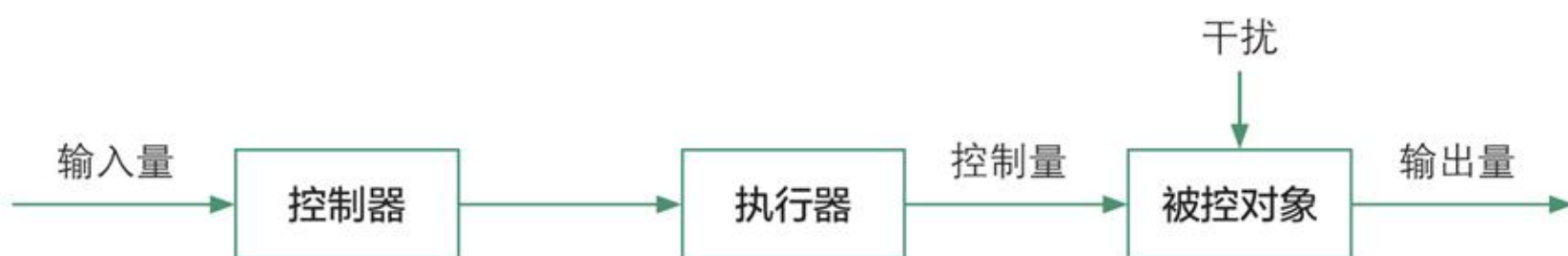
图4-17 开环控制系统的干扰情况
