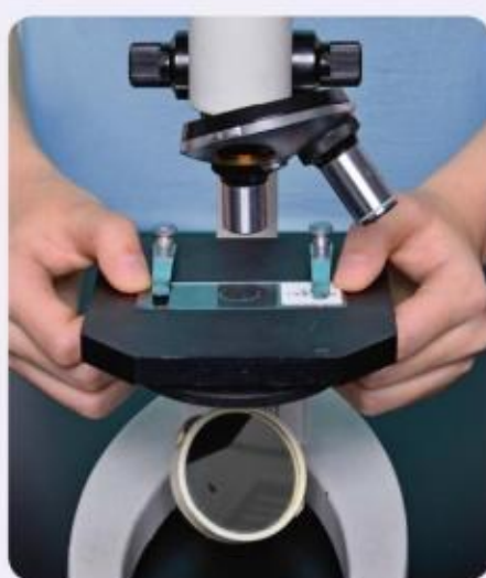
② 在低倍镜下观察清楚后，把要放大观察的目标移至视野中央。
