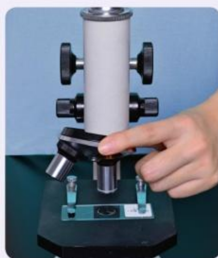
③ 转动转换器，换成高倍物镜。
