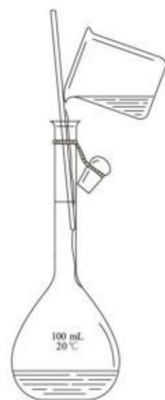
图 2-25 向容量瓶中转移溶液
