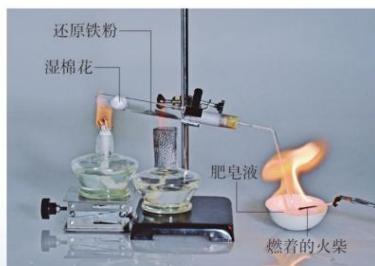
图3-5 铁粉与水蒸气反应
