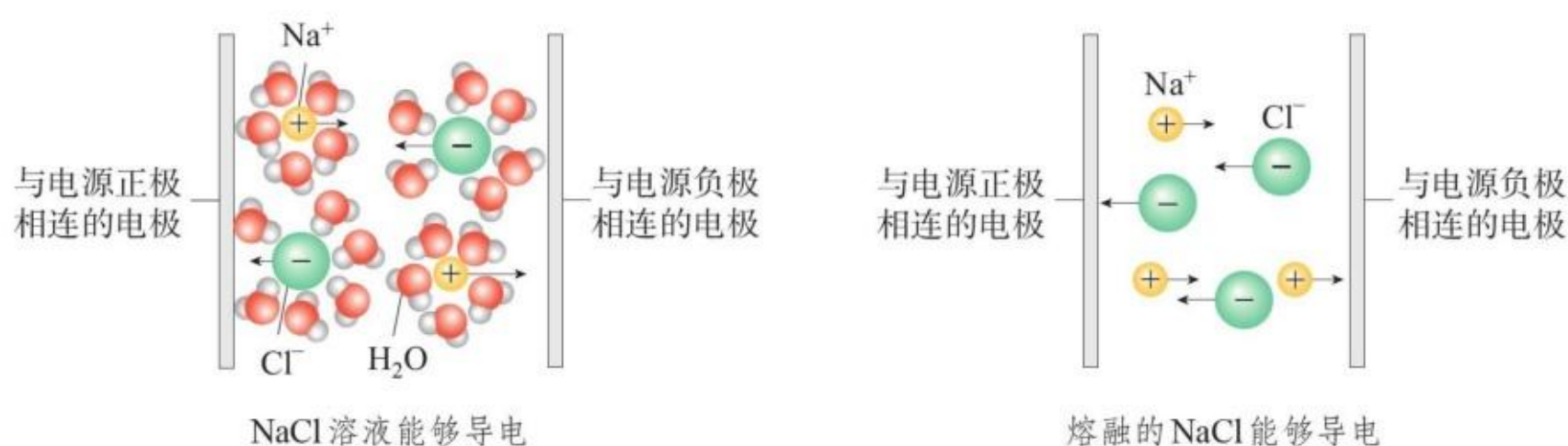
图1-12 NaCl导电示意图
