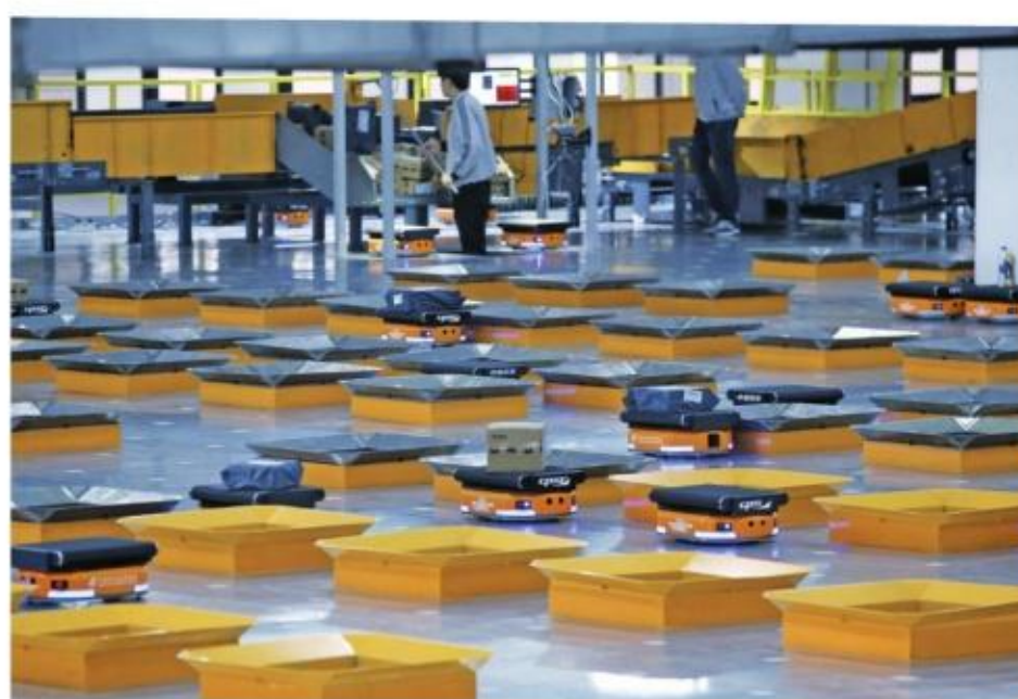
图 1-2 智能机器人正在对快递物品进行分拣
