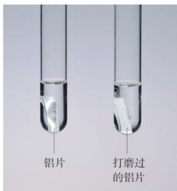
图3-17 将铝片放入NaOH溶液中
