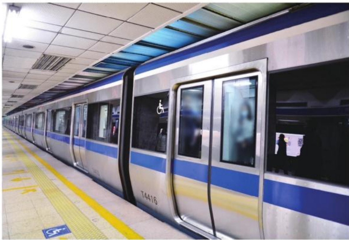
图3-15 用不锈钢制造的地铁列车的车体
