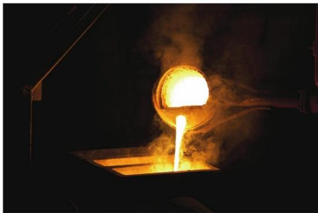
图3-4 钢水注入干燥的模具
