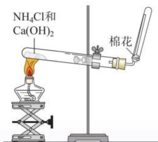
图 5-13 实验室制取氨的简易装置示意图
