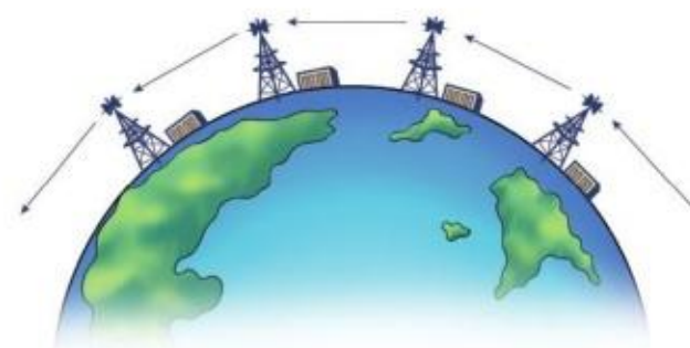
图21.3-2 微波中继通信示意
