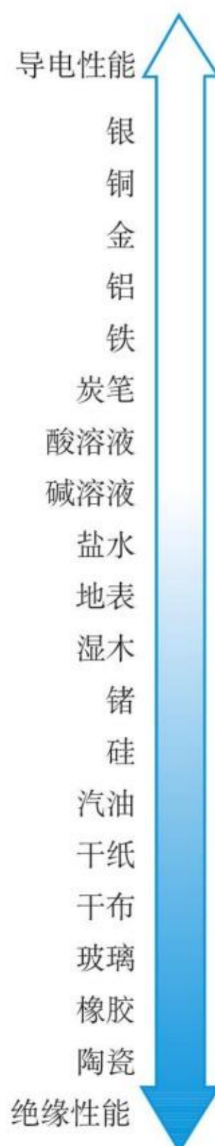
图16.3-5 不同材料的导电性能
