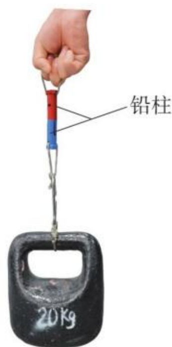
图13.2-5 用铅柱吊起重物
