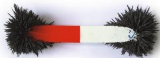
图20.1-4 条形磁体两端的磁性最强
