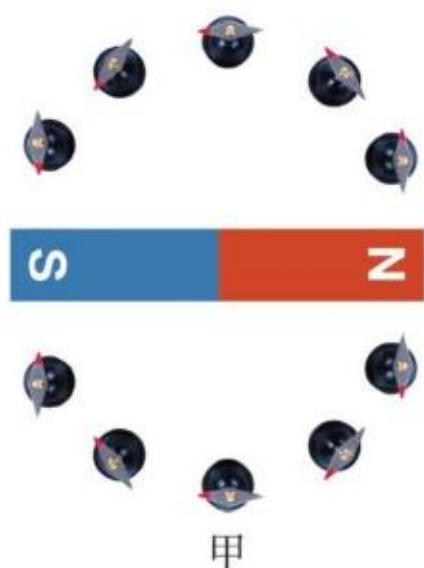
图20.1-6 条形磁体磁场的分布
