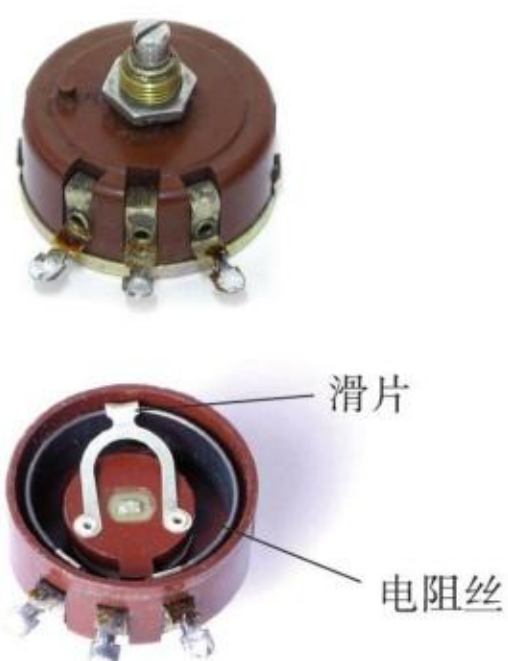
图16.4-5 一种电位器的结构
