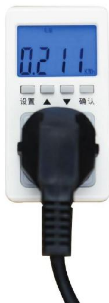
图 18.3-1 测量消耗的电能
