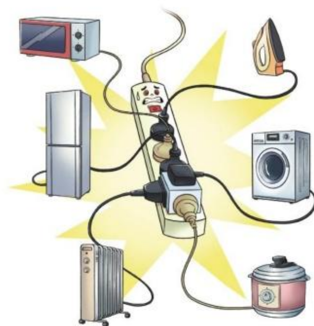
图19.1-2 用电器的总功率过大容易引发火灾
