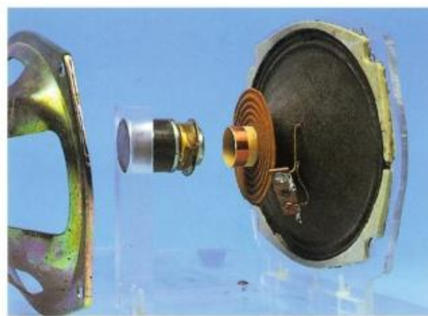
图20.4-6 扬声器的结构
