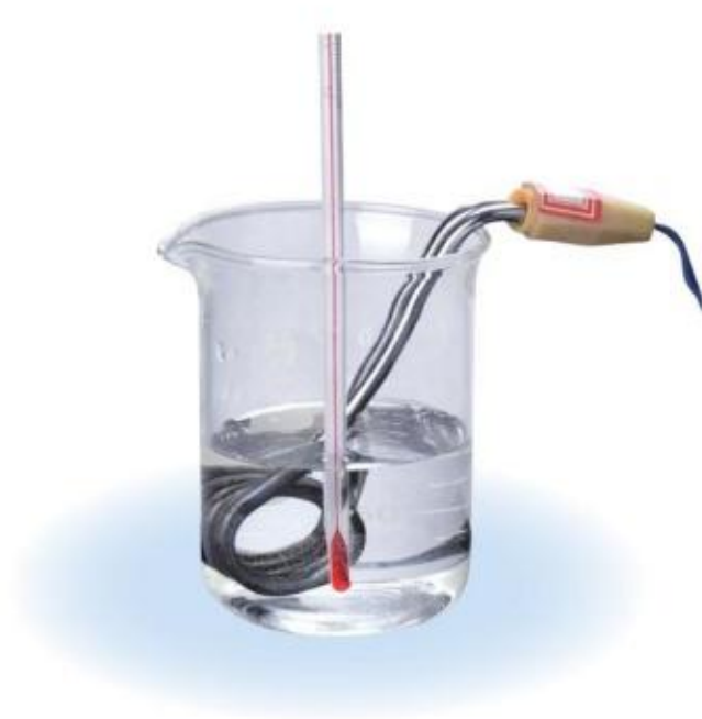
图13.1-2 用电加热器加热水
