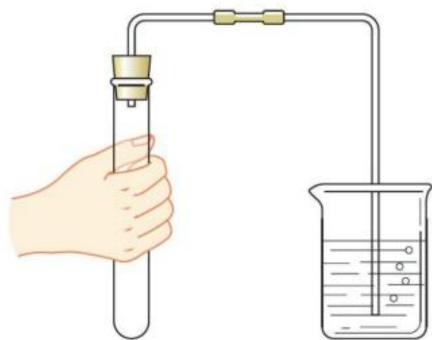
图 1-25 检查装置的气密性
