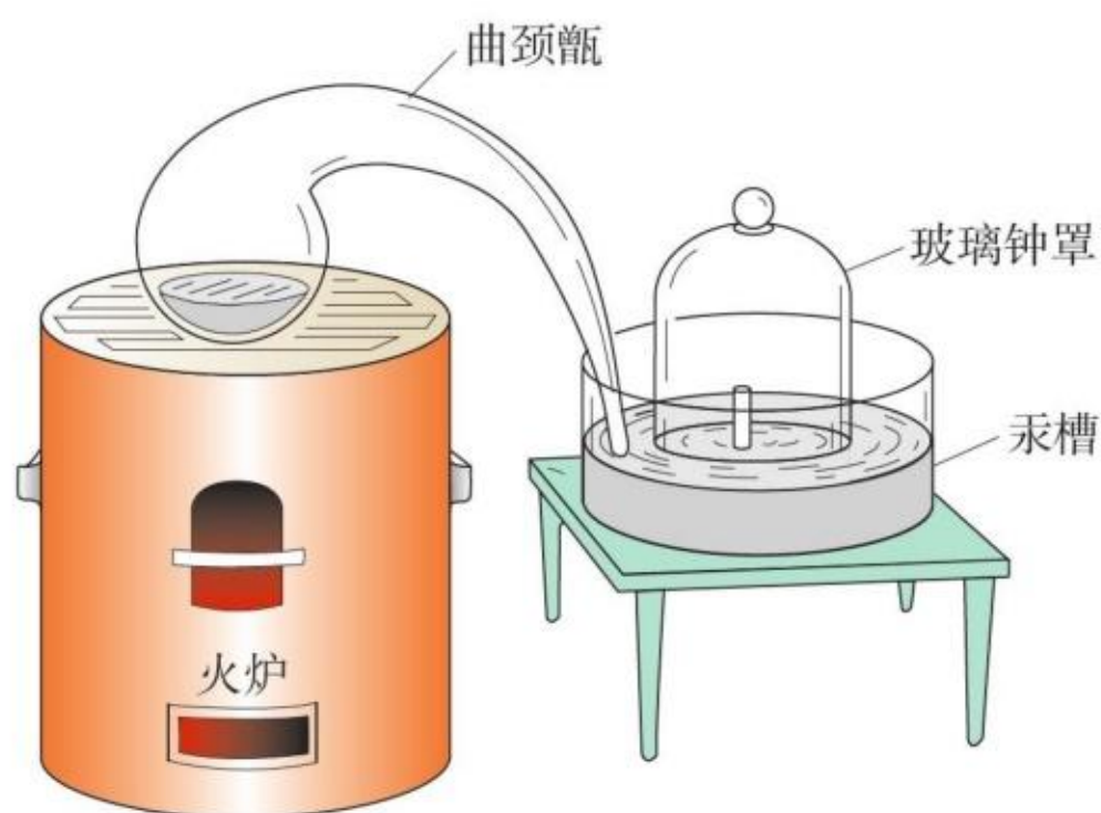
图2-2 拉瓦锡研究空气成分所用的装置示意图
