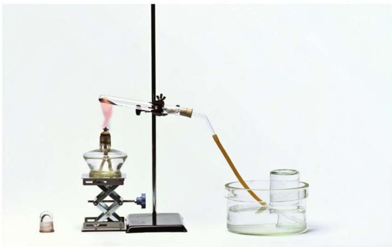
图2-14 高锰酸钾分解制取氧气
