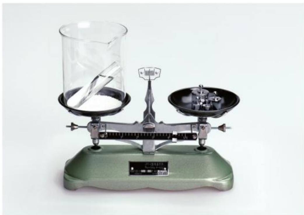
图5-3 盐酸与碳酸钠反应及质量测定的装置
