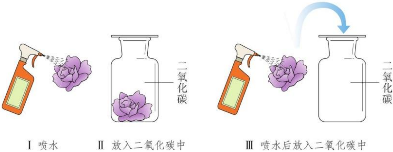
图 6-12 二氧化碳与水反应的实验示意图
