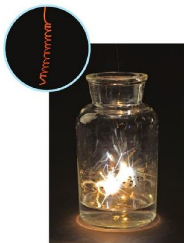
图2-13 铁丝在空气中加热时红热，在氧气中点燃发生剧烈燃烧
