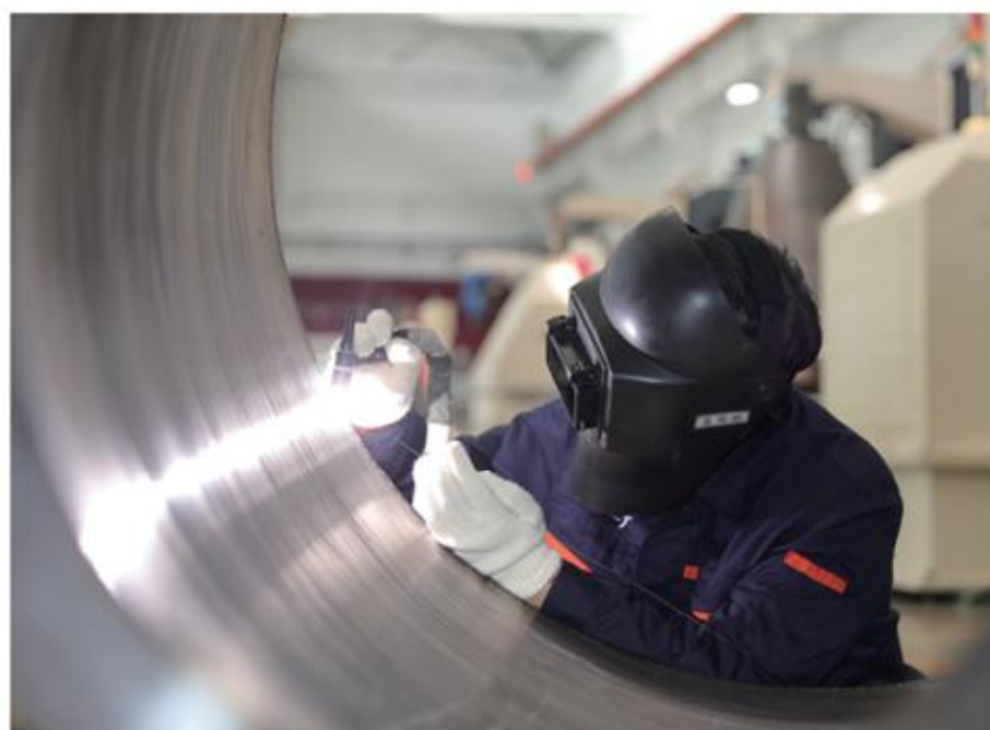
图8-8 我国工匠正在焊接火箭发动机喷管
