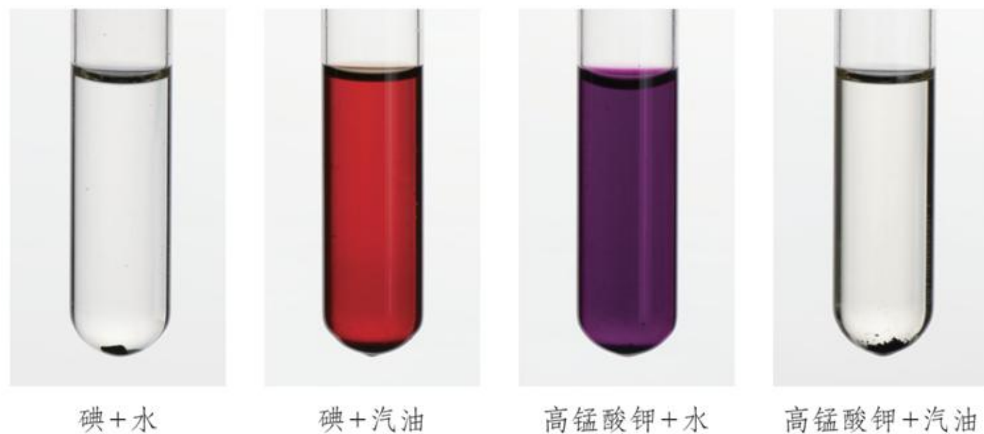
图9-3 碘和高锰酸钾的溶解性比较
