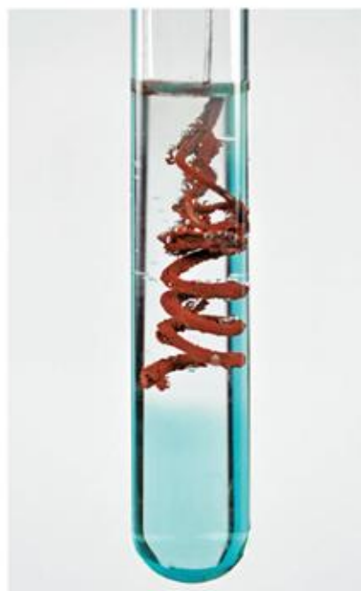
图 8-11 铝与硫酸铜溶液的反应
