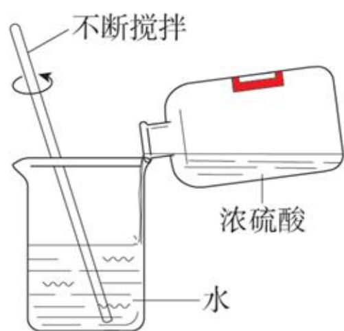
图10-7 稀释浓硫酸的正确操作
