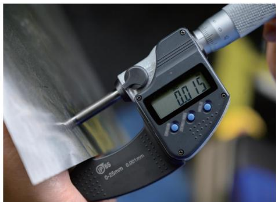
图8-7 我国生产的超薄不锈钢精密箔材
