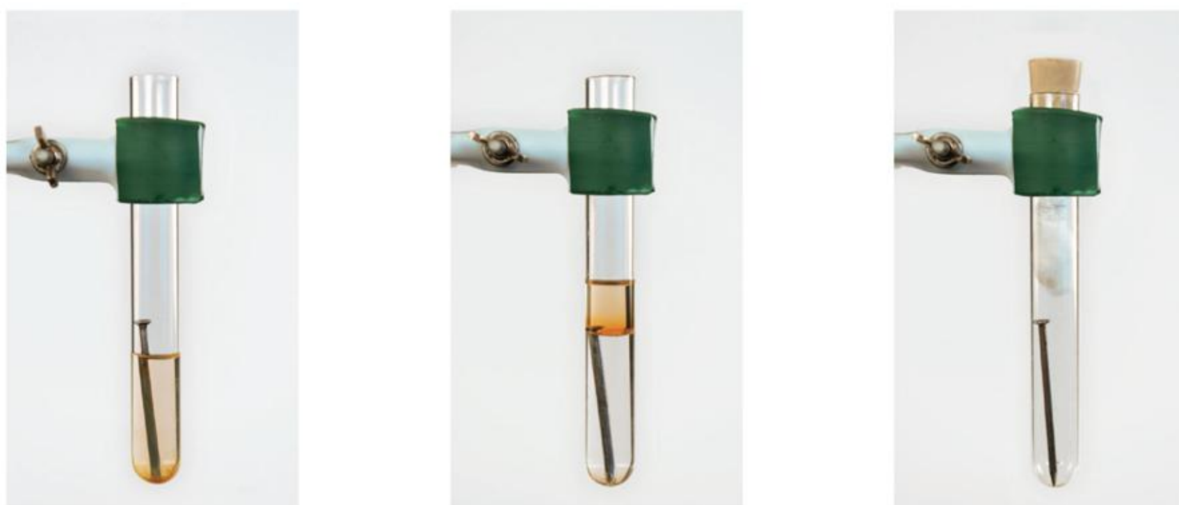
图 8-18 铁钉生锈条件的探究实验（放置一周后）
