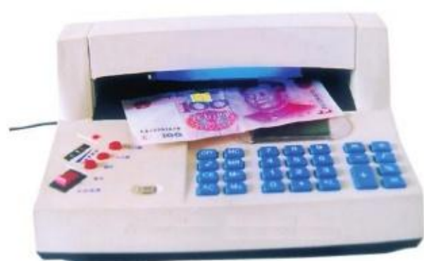
图4.5-7 紫外线使钞票上的荧光物质发光
