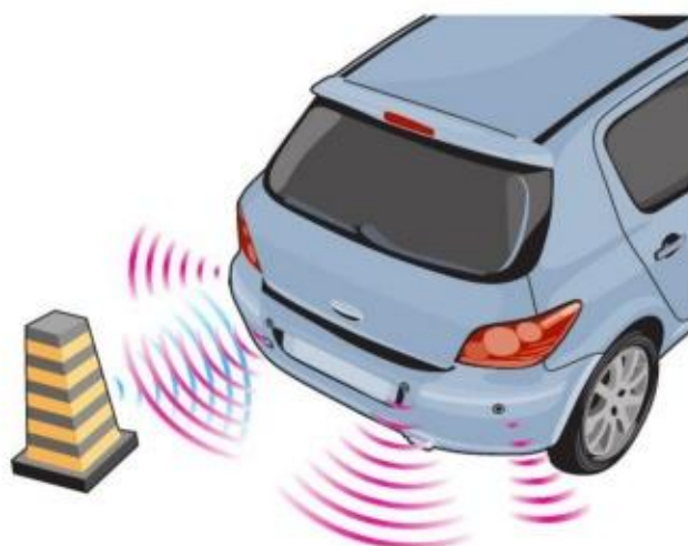
图2.3-4 利用超声波定位的倒车雷达
