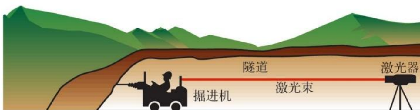
图4.1-5 激光引导掘进方向
