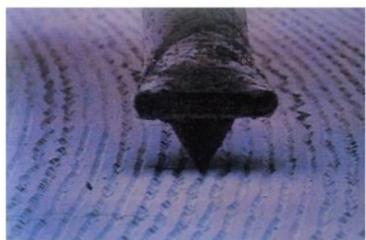
图2.1-3 机械唱片表面的沟槽
