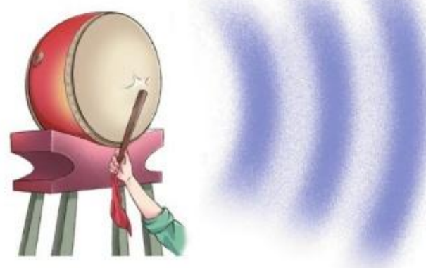
图2.1-5 鼓面的振动激起声波
