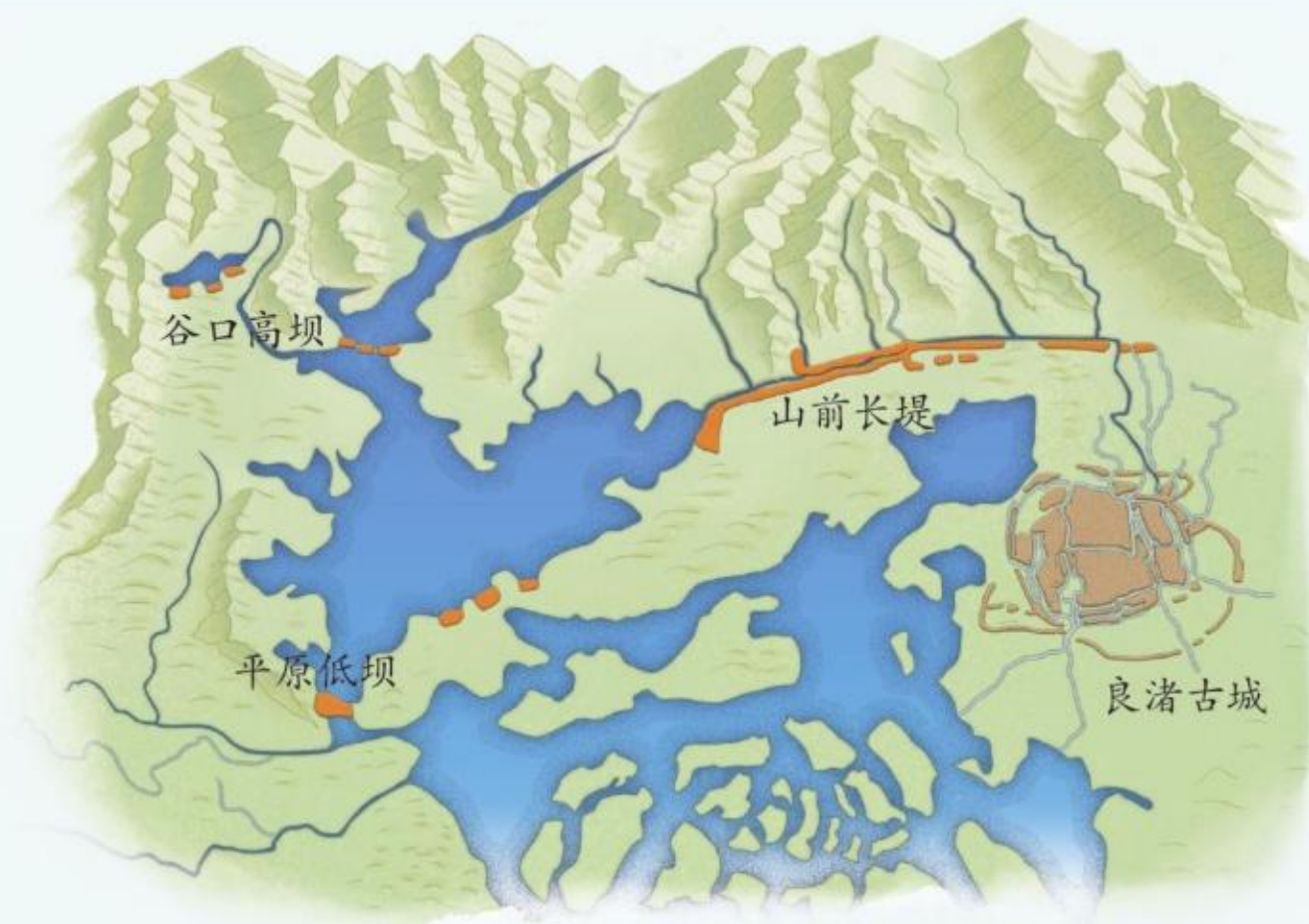
图 3.13 良渚古城的水利工程
