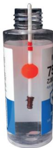
图10.4-6 用微型密度计测量小瓶酒精的密度
