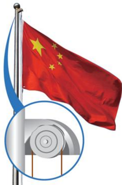
图12.3-2 旗杆顶部的定滑轮
